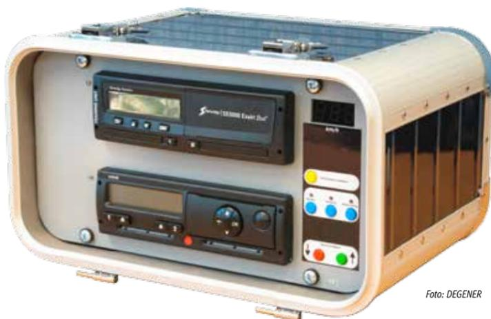
Der Schulungs-Koffer ist auch mit nur einem digitalen Tachographen erhältlich – mit dem VDO DTCO 1381 oder dem Stoneridge Exakt Duo.
