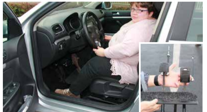
Christina ist kleinwüchsig, Fußraum-erhöhung und Pedalaufsatz ermöglichen ihr die Bedienung der Pedale. Frank Schmidt demonstriert die Funktion direkt vor dem Umbau zur Prüfung.
