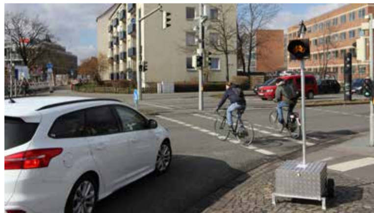
„Amber Light“ warnt abbiegende Autofahrer vor einer Kollision mit Radfahrern.
