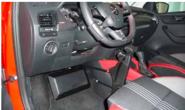
Optimale Voraussetzungen! Der Umbau für Maïke S. ist bereits realisiert. Zur Verfügung steht ab sofort ein Skoda Fabia mit Handsteuerungshebel und Trittplatte zum Abdecken der Pedale.
