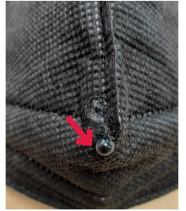
Das Equipment wird immer kleiner und feiner. Längst nicht alle Gerätschaften können mit dem Detektor erkannt werden. Oberhalb des Stecknadelkopfes kaum erkennbar, die Kameralinse.
