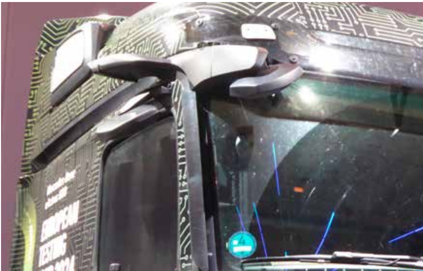
Kamera- und Spiegelanordnung am Mercedes-Benz eActros 600
