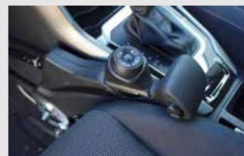
Handbediengerät für Gas- und Betriebsbremse als Kombination mit einer Hand zu betätigende Vorrichtung; Schalter mit Sekundärfunktion.
