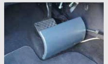
Abdeckung durch eine Pedalsperre.
